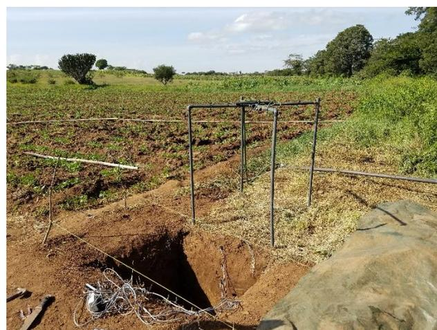
**Fig. 3.** Diseño experimental. Se muestra una de las tres zanjas excavadas para instalar los sensores de humedad (insertados en la única pared abierta al exterior de la parcela). Sobre la parcela se observa un simulador de lluvia fabricado en PVC. La superficie interior del simulador tiene 1m de lado. El dispositivo tiene 1.5m de altura, y 4 micro aspersores, cada uno situado en una de las diagonales del simulador, a 0.45m de distancia del exterior.
