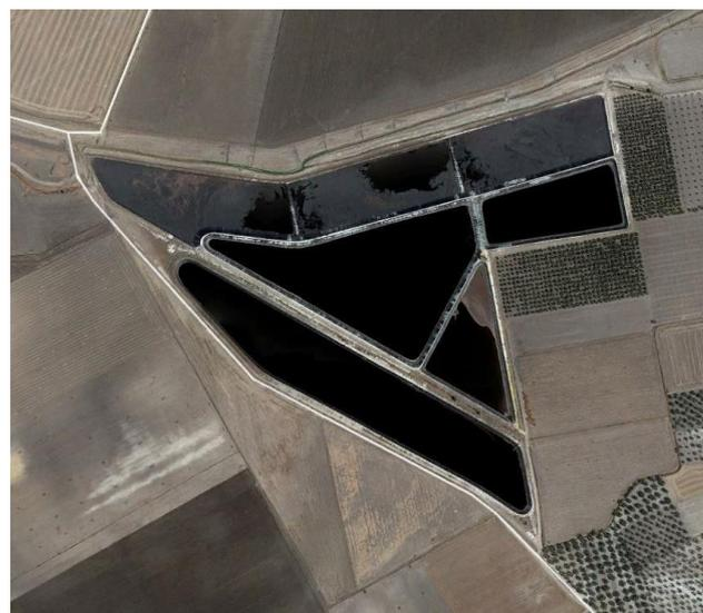
**Fig. 1.** Balsas de evaporación de aguas residuales de la industria de aderezo de aceituna de mesa de 24 ha ubicadas en la provincia de Sevilla (Google Earth, 2016).
