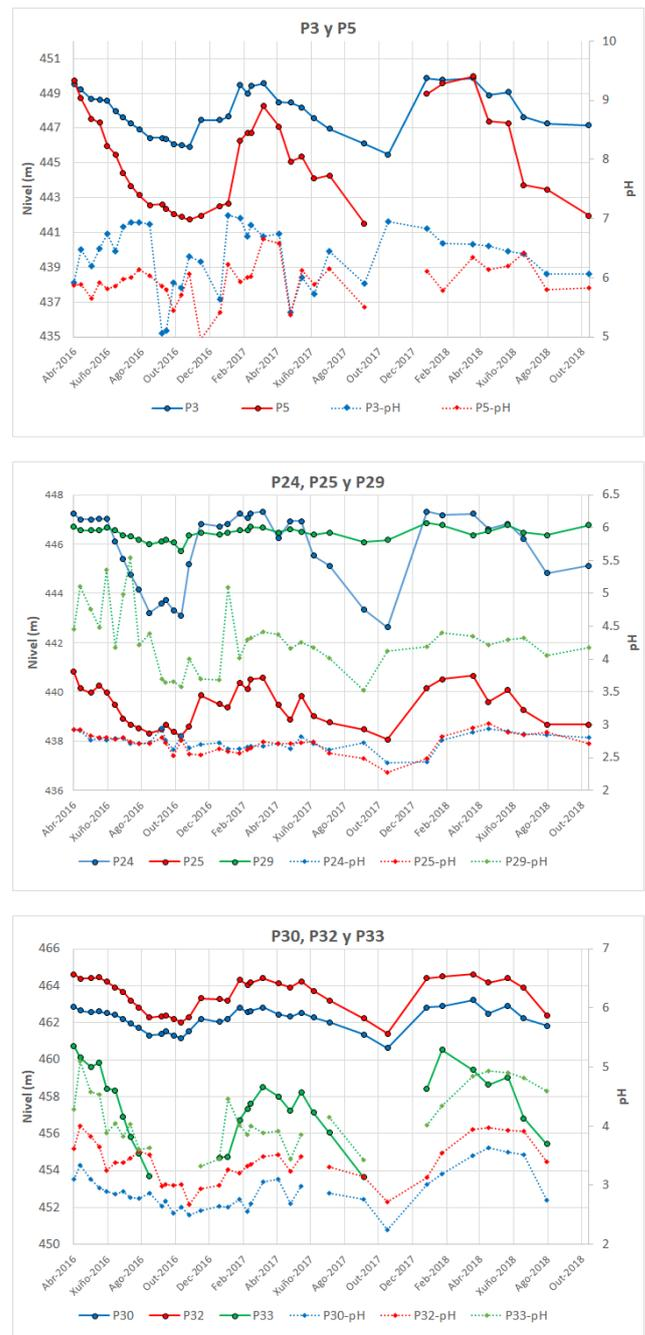
**Fig. 10.** Evolución temporal de los niveles piezométricos y del pH en los piezómetros P3 y P5 situados en zonas no afectadas por los drenajes ácidos (figura superior), los piezómetros P24, P25 y P29 situados en el terraplén del Aparral (figura intermedia) y los piezómetros P30, P32 y P33 situados en el área de descanso.
