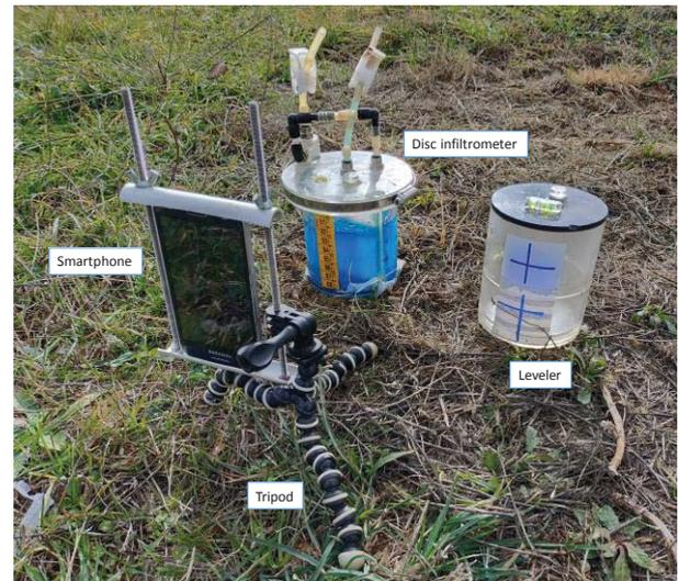
Fig. 1. Infiltrómetro de disco.
