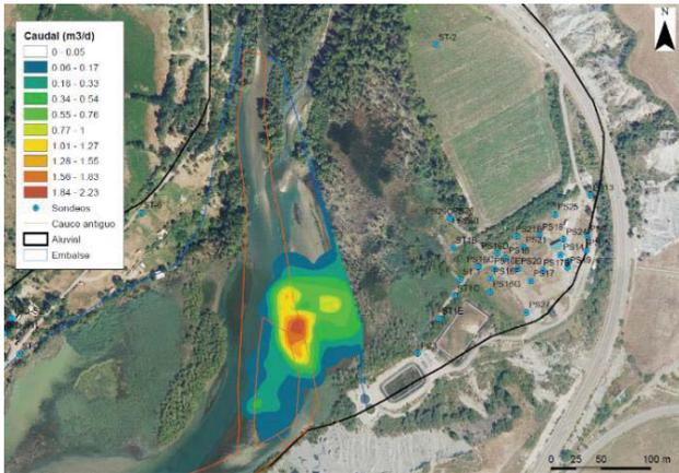
Fig. 10. Caudales nodales de descarga ( $m^3/d$ ) al embalse del agua procedente del vertedero de Sardas al cabo de cincuenta años de simulación.
