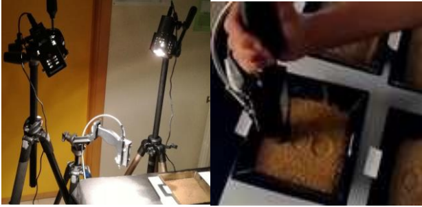
Fig. 3. De izquierda a derecha, medición de las muestras con pistol grip (fibra óptica) y sonda de contacto.
