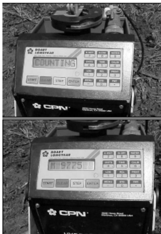
Fig. 3. Sonda de neutrones realizando el computo relativo.
