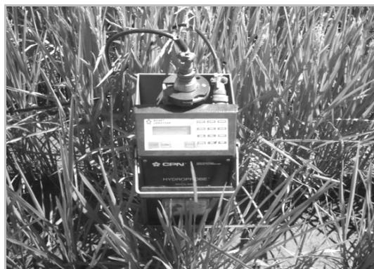
Fig. 1. Sonda de neutrones utilizada en el proyecto de investigación.
