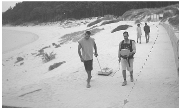
Fig. 7. Toma de datos en las Islas Cíes con una antena apantallada de 250 MHz. La flecha indica el eje del vial sobre el que se efectuó el estudio, constituido por losas de hormigón que permanecen ocultas bajo la arena.
