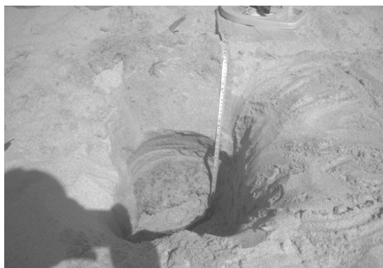
Fig. 11. Cata realizada en el metro 28 del perfil de la Fig. 10 donde se aprecian la profundidad y los límites de la placa de fuel detectada.
