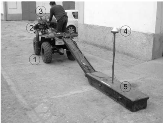
Fig. 3. Equipo móvil de inducción electromagnética. (1) ATV; (2) receptor DGPS (3) ordenador de campo; (4) antena DGPS; (5) trineo con sensor EM38DD
