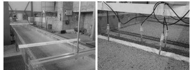
Fig. 1. Vista aguas abajo del canal hidráulico. Colocación de los conductímetros.
