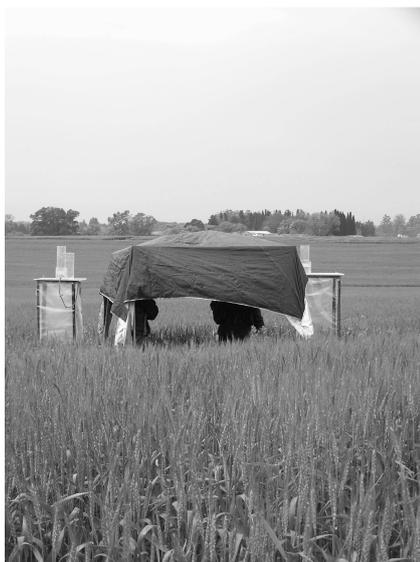
Fig 2. Momento de medición a campo donde se muestra el trabajo con dos simuladores de lluvia.
