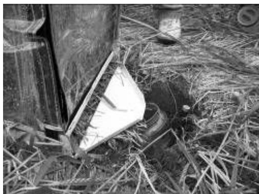
Fig 3. Recolección de agua escurrida y sedimento de suelo luego de la simulación del efecto de la lluvia.
