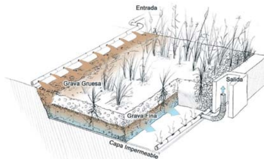
Fig. 1. Esquema de un humedal artificial de flujo sub-superficial horizontal para la depuración de agua residual
