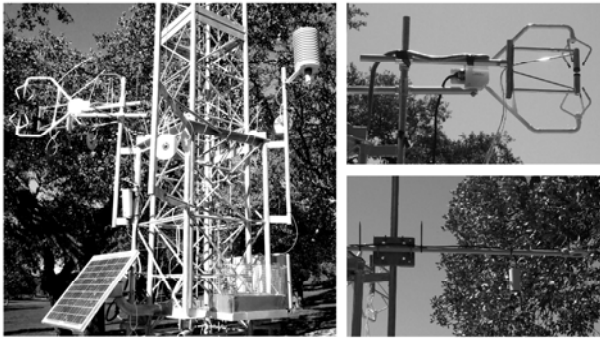
Fig. 4. Sistema de medida. CSAT3 y KH20. Radiómetro Neto
